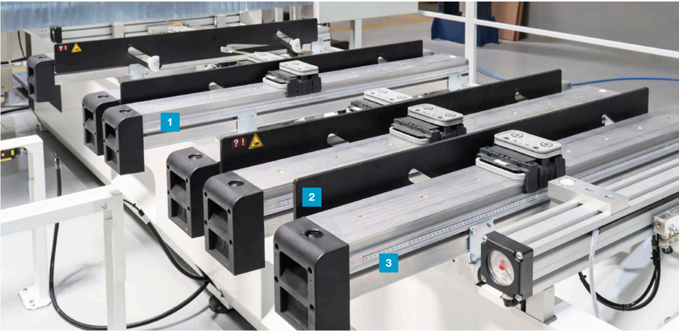
3-4-Achsen Modell: Starke, einfach zu positionierende Konsolen - geeignet für 50 mm hohe Vakuumsauger
