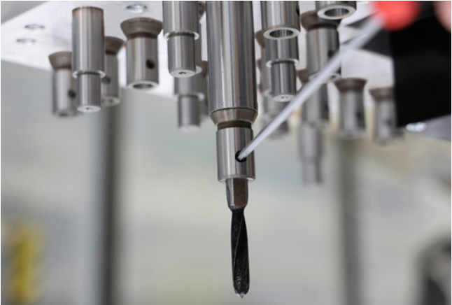
KlassischesWeldon-Wechselsystem für einen Bohrerwechsel mit Werkzeugen
