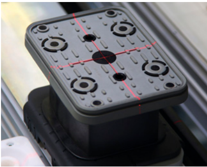
Option: LASER-Positionierhilfe LASER-Positionierhilfe – Vakuumsauger werden mit einem Laser-Fadenkreuz angezeigt. Als Positionierhilfe für Freiformteile kann die Werkstückkontur „abgefahren“ werden
