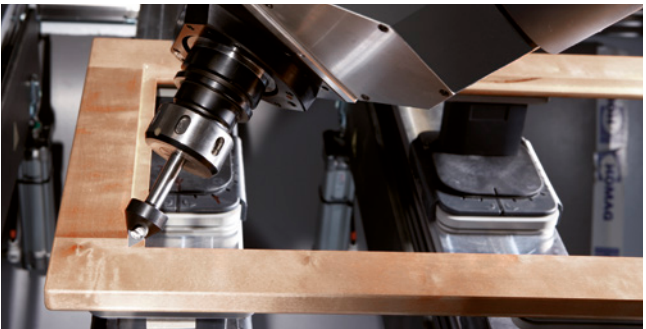
Eckiges Ausspitzen einer Glasfalz-Ecke
