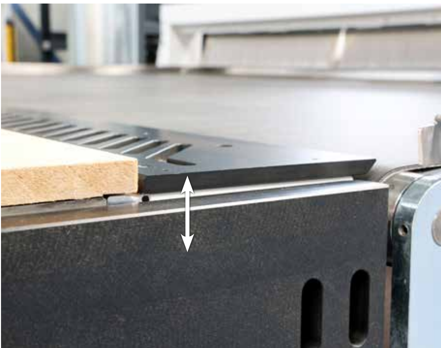
Absaugung von oben über dem Gurtband
