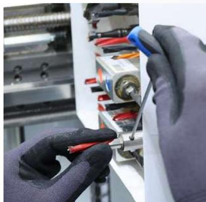
**Weldon Wechselsystem** für einen Bohrerwechsel mit Werkzeugen
