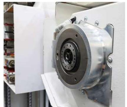
Sägen, Fräsen und Bohren mit unserer Standard-Aggregateschnittstelle.
